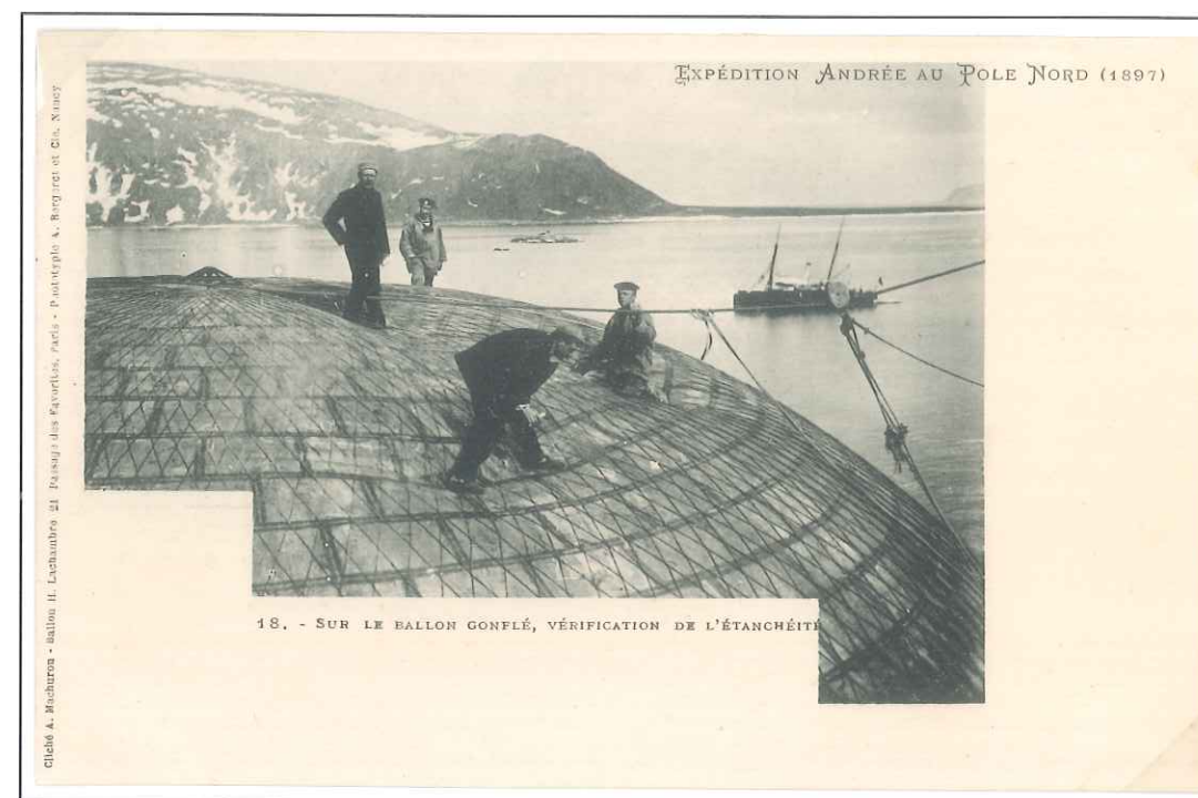
KORT NR 18. Ofrankerat vykort. Utgivet av Cliché A. Machuron - Ballon H. Lachambre, Paris 1897. Motivet visar toppen av den vätfäskyllda ballongen. Kontroll sker av gasläckage.
